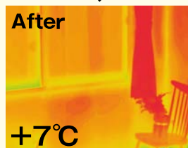
今ある窓+内窓(インプラス) / 単板ガラス3mm+Low-E複層ガラス 5°C 30°C サーモグラフィ撮影条件 室外温度0°C、室内温度20°C
